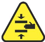
**1) PERICOLI DI SCHIACCIAMENTO** Durante la movimentazione del piano rete esistono rischi residui di schiacciamento delle mani tra le parti mobili del meccanismo e la struttura fissa del letto (rischio residuo di schiacciamento)
